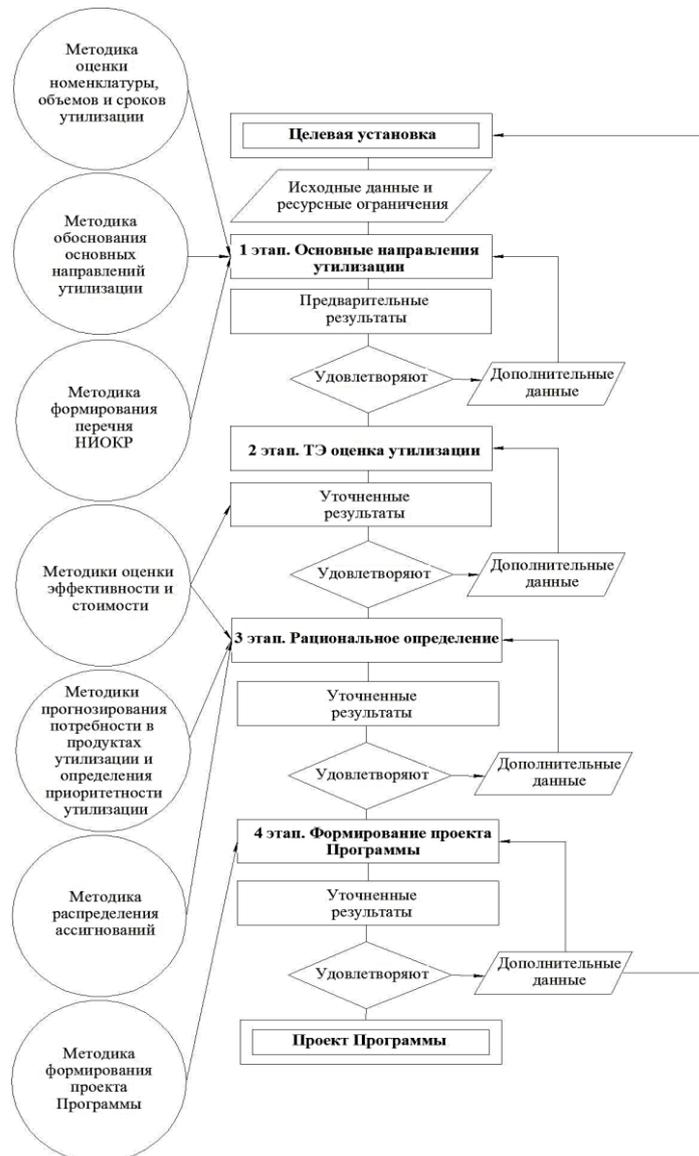
Рис. 1 – Структурная схема научно-методического сопровождения разработки проекта утилизации сельскохозяйственной техники в системе АПК
