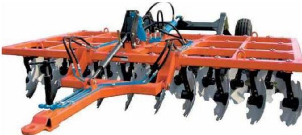
Рис. 1 – Бороны дисковые модульные БДМ-4х4П «М»
